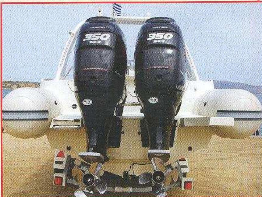
του Top Line 33). Τα 1.90, 2.06, 2.52 και 2.81 lt/h που αντιστοιχούν στους 38.5, 46, 53 και 59 κόμβους, θεωρούνται όχι μόνο λογική αλλά χαμηλή κατανάλωση για δεκάμετρο σκάφος με κινητήρες συνολικής ισχύος 700 HP.
