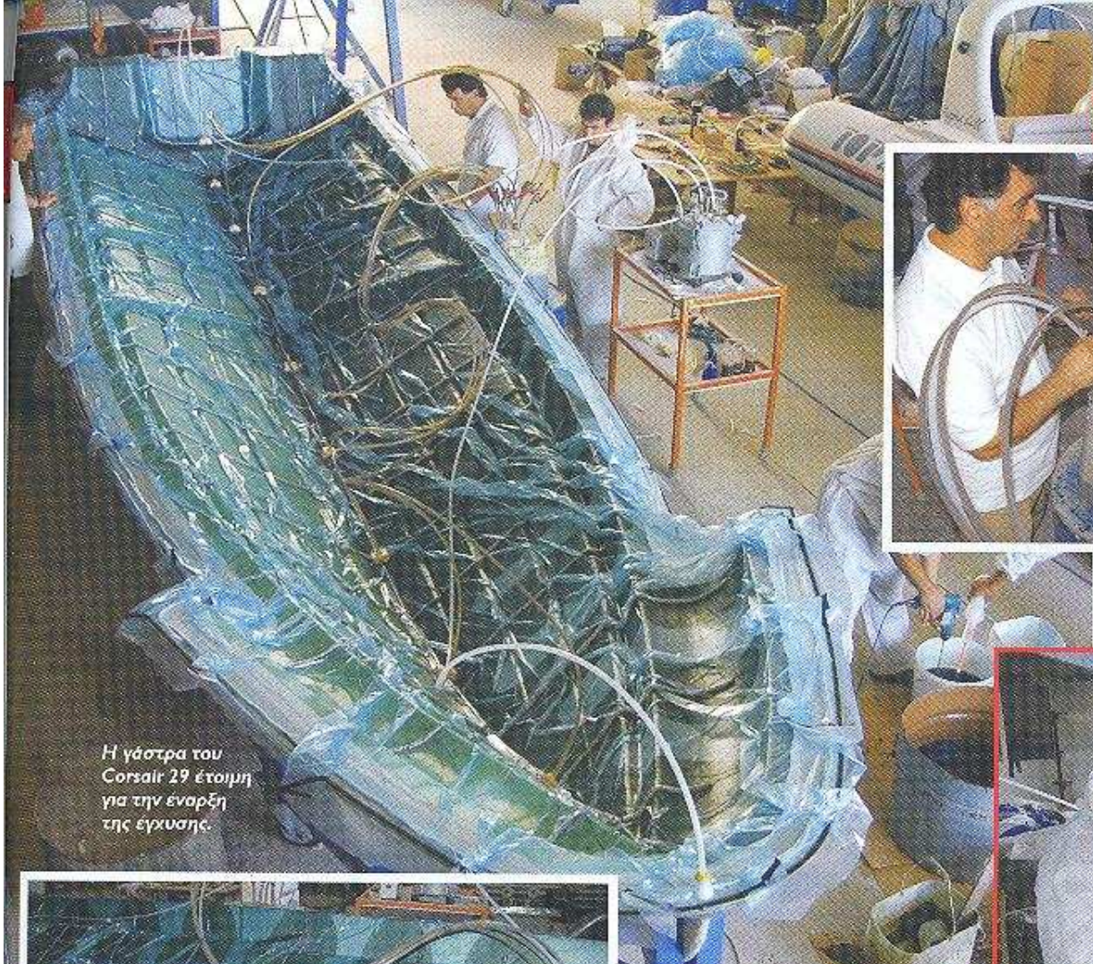
Στην φωτογραφία φαίνεται το πως ολοκληρώνεται ο εμποτισμός εν κενώ (με σκούρο χρώμα η επιφάνεια που ήδη έχει εμποτισθεί).
