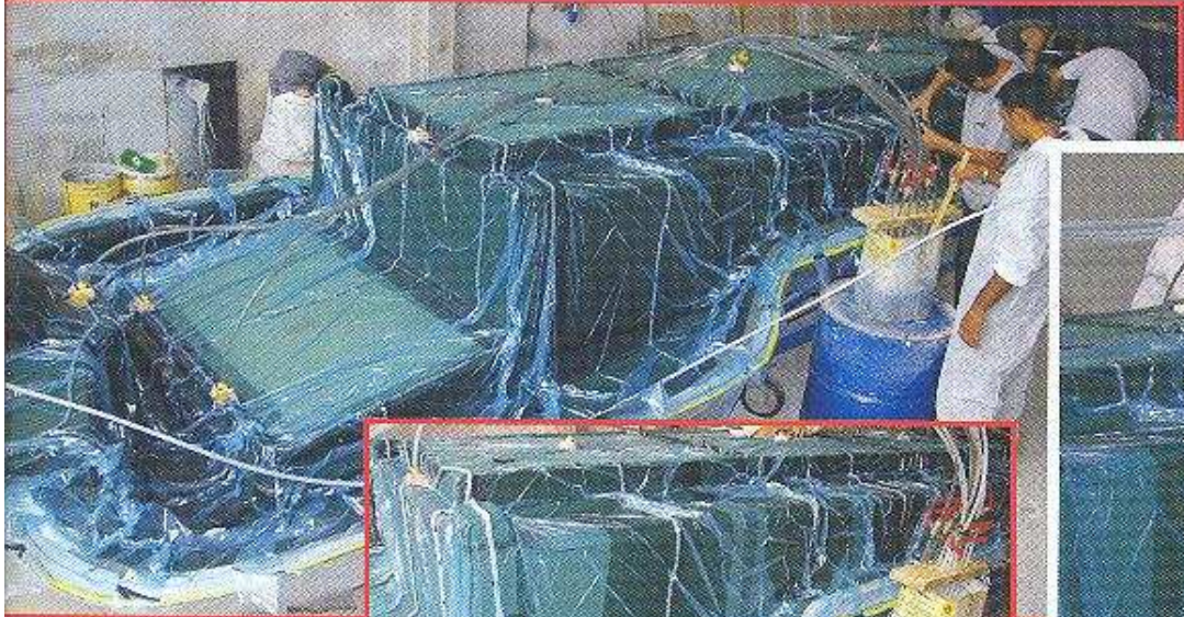
Η σωστή ροή και ο επιτυχημένος διαποτισμός των υαλοφασμάτων εξαρτάται από την μελέτη και τοποθέτηση των καναλιών ροής.
