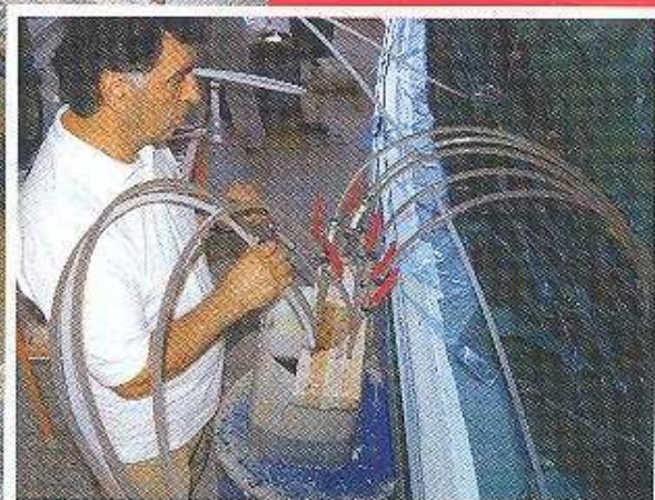
Ένα σύστημα βανών διασφαλίζει τον έλεγχο ροής στα ακροφύσια εγχυσης.
