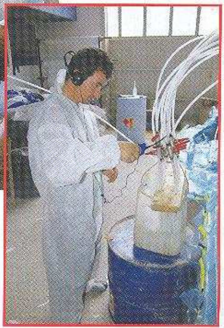
Ένα σύστημα βανών διασφαλίζει τον έλεγχο ροής στα ακροφύσια εγχυσης.
