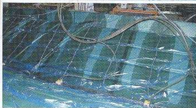
Στην φωτογραφία φαίνεται το πως ολοκληρώνεται ο εμποτισμός εν κενώ (με σκούρο χρώμα η επιφάνεια που ήδη έχει εμποτισθεί).
