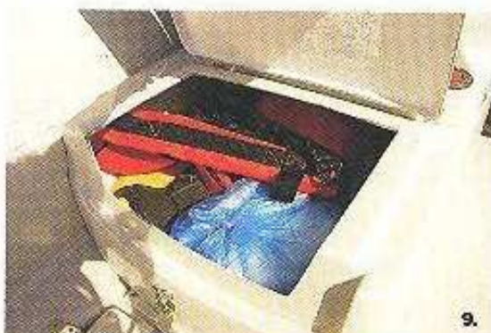
6: Στην πίσω πλευρά των καθισμάτων κυβερνήτη-συγκυβερνήτη βρίσκεται ένα στεγανό ντουλάπι, δίνοντας άλλη μία αποθήκη
